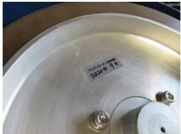
ローターのゴム・ウレタンは日々劣化します。古くなり劣化したローターは、高速回転させるとひび割れやウレタンが欠けて飛び出すなど危険ですので、絶対に使用しないでください。
